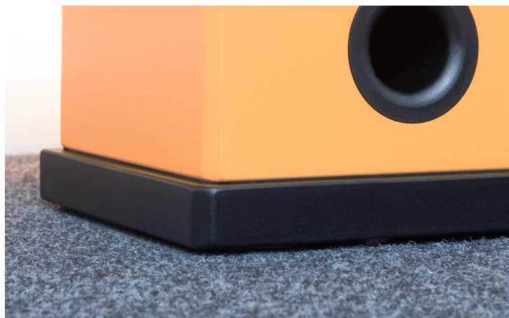
Der leicht überragende Sockel veredelt das Design der Sabero, befördert ihre Standfestigkeit und dient ebenso der Schwingungsdämpfung: Zwischen Korpus und Bodenplatte ist eine filzartige, vibrationsmindernde Matte eingezogen.
