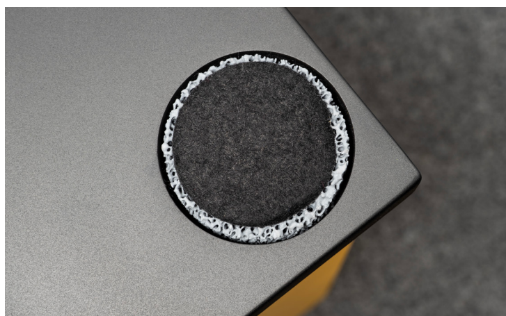
Einer der insgesamt vier Schwingungsdämpfer, die in die Bodenplatte eingelassen sind. Diese Pucks bestehen aus Kunstkoralle: Das harte Material sorgt mit seiner geringen Dichte und offenporigen Struktur für eine effektive Entkopplung des Lautsprechers vom Untergrund. Die darauf aufgeklebten schwarzen Filz-Scheiben sorgen dafür, dass der Fußboden unversehrt bleibt.
