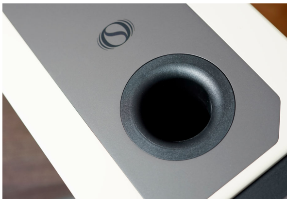
Der Bassreflexport der Orbid Sound Maridur sitzt auf der Vorderseite unten
