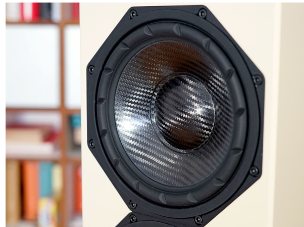
In der Maridur stecken je zwei Beyma-Woofer vom Typ 8NMFW – sie besitzen Carbonfaser-Membranen
