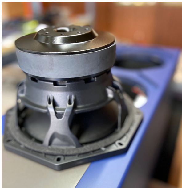
Blick auf einen ausgebauten Beyma-Woofer der Orbid Maridur
