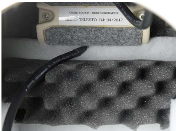
Blick auf die vergossene Frequenzweiche der Orbid Sound Telesto
