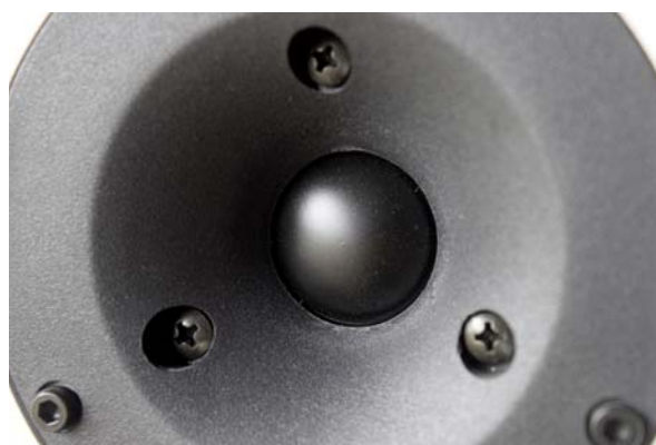
Die Hochtonkalotte sitzt in einer hornartigen Vertiefung
