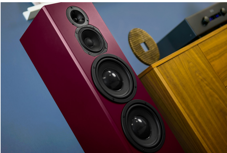
Wer die Treiber des 3-Wege-Systems mit einer Abdeckung verhüllen möchte, sollte dies schon beim Bestellen beachten. Die benötigten Halterungen müssen bereits beim Bau der Lautsprecher integriert werden.
